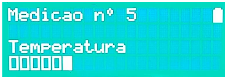
Figura 14 – display LCD do MCE-HC05 mostra barra de andamento das medições e o salvamento de dados do ciclo de medição numero 5
